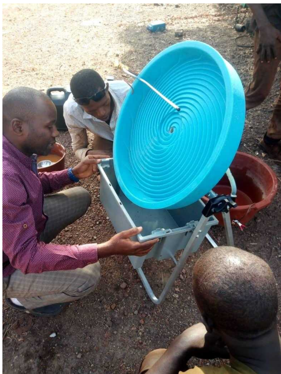
Montage du concentrateur à spirales par les artisans locaux
